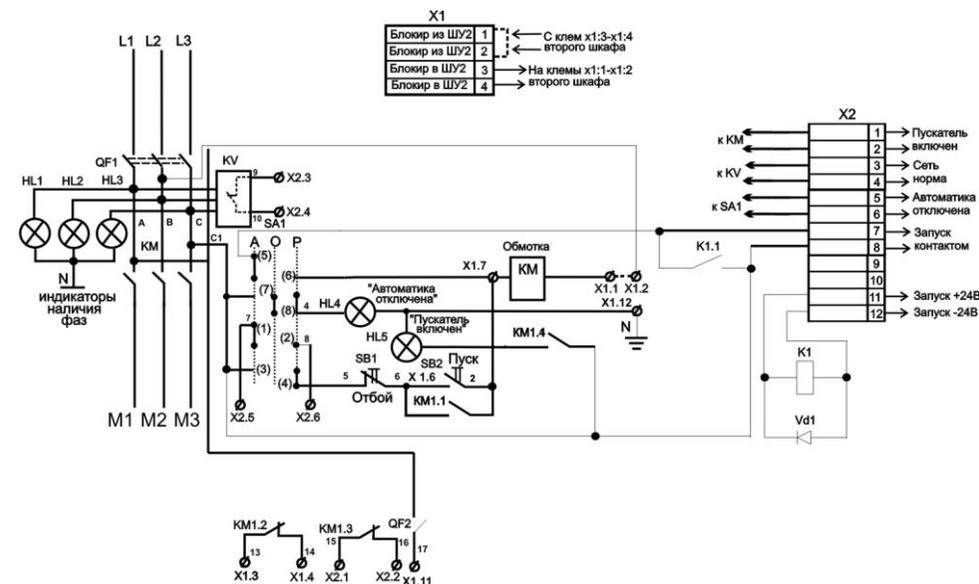
Рис.2 - Схема ШУ с рабочим напряжением 380 В
