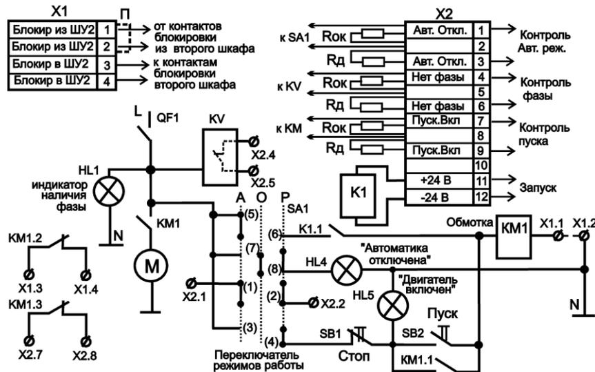
Рис. 1 - Схема ШУ с рабочим напряжением 220 В
